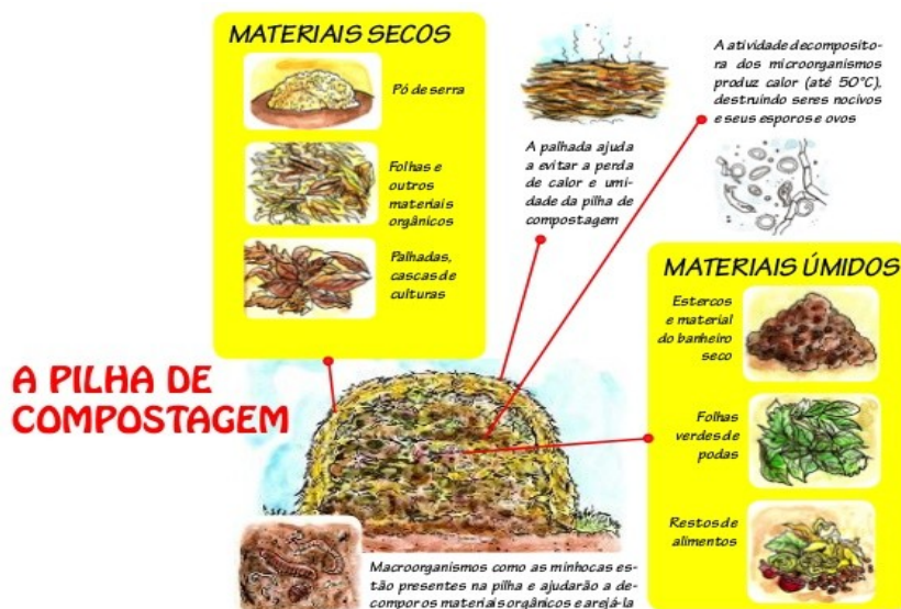
Figura 11. Pilha de compostagem ilustrativa com indicações dos materiais secos e úmidos. Fonte: Cepagro - Coleção saber na prática: Volume I Banheiro seco - Saneamento como princípio agroecológico e resposta à crise de água.
