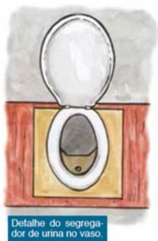
Figura 7: Exemplo de vaso com segregador de urina
